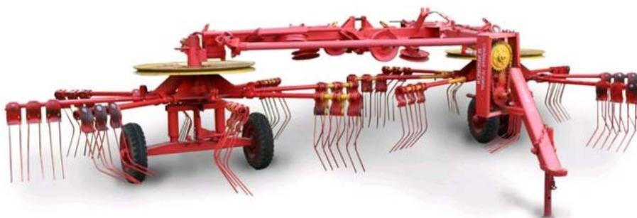
Грабли-ворошилка ГВР-6Р предназначены для сгребания в валки травы из прокосов и ворошения скошенной массы. Оборачивают и разбрасывают валки.
