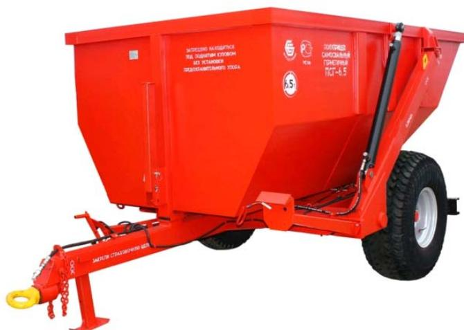
Полуприцеп самосвальный герметичный ПСГ-6,5 — универсальное всесезонное транспортное средство. Предназначен полуприцеп для транспортировки и разгрузки полужидкой органики, торфа, торфокомпостных смесей, твердых органических удобрений и любых других сыпучих грузов.
